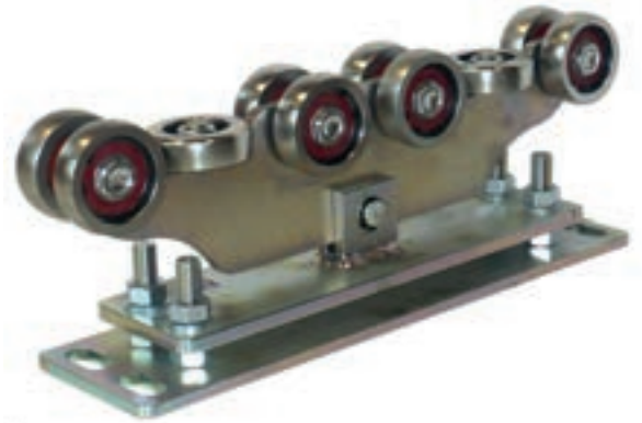
WBR-10B 10 rolkowy wózek z 8 rolkami do przeniesienia ciężaru z wzmocnionymi łożyskami i 2 rolkami prowadzącymi szynę brama od 6 do 10 metrów wjazdu
