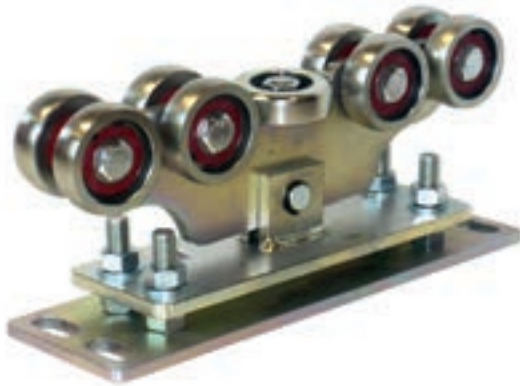
WBR-9B 9 rolkowy wózek z 8 rolkami do przeniesienia ciężaru z wzmocnionymi łożyskami i 1 rolką prowadzącą szynę brama od 6 do 9 metrów wjazdu
