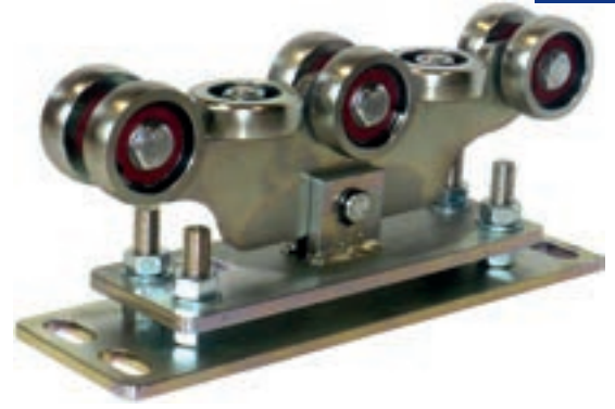
WBR-8B 8 rolkowy wózek z 6 rolkami do przeniesienia ciężaru z wzmocnionymi łożyskami i 2 rolkami prowadzącymi szynę
